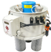
SP Décolmatage cartouches par contre-courant d'air Filtre antistatique classe M (EN 60335-2-69), 3 cartouches polyester antistatique, 9 m 2 surface filtrante
